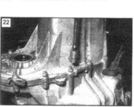
22 Ключом "на 13" отворачиваем двенадцать гаек и один болт, соединяющий коробку передач с картером сцепления.
