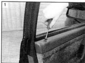
Отверткой выворачиваем кнопку блокировки замка двери.
