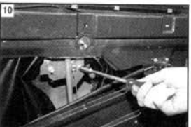
Ключом "на 10" отворачиваем два болта крепления обоймы стекла к кронштейну стеклоподъемника.
