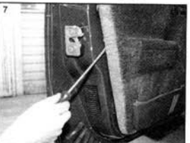
Плоской отверткой поддеваем обивку в местах расположения восьми пластмассовых фиксаторов и освобождаем их из двери.
