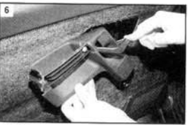
...и, поворачивая, снимаем ручку.
