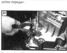
20 Ключом "на 13" отворачиваем пробку фиксатора заднего хода.
