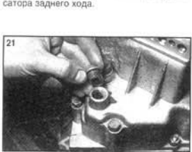
21 Чтобы достать из картера пружину и шарик, коробку придется наклонить.
